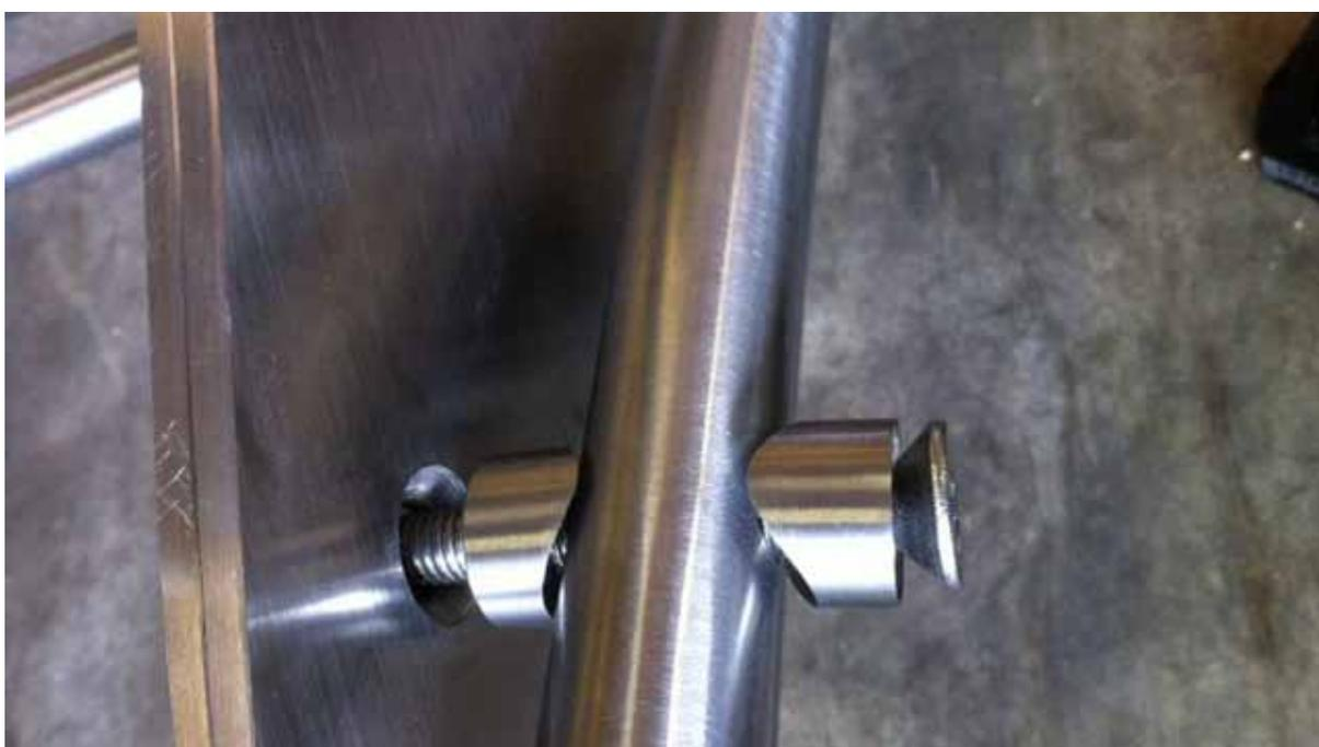
Schritt 2: Die Lagerhülsen für die Tischplatte oben und unten in das Halterungsrohr stecken
